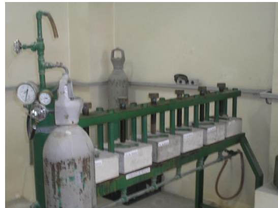
Instalación del ensayo DIN 1048
